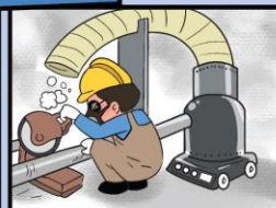
ใช้อุปกรณ์ปิดครอบ/ควบคุม แหล่งกำเนิด ป้องกันฝุ่นฟุ้งกระจาย
